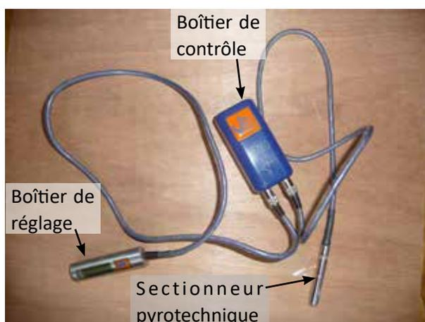
Il déclenche l'ouverture en sectionnant la bouclette de fermeture du conteneur du parachute de secours.
