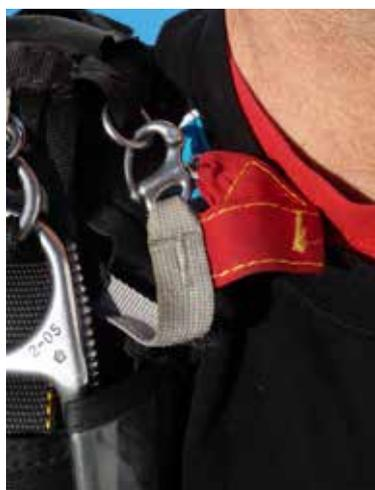
Afin de pouvoir éventuellement libérer la voile principale sans provoquer l'ouverture de la voile de secours (par exemple en cas d'atterrissage par vent fort ou sur un plan d'eau), le LOR ou le Stevens est débrayable par l'intermédiaire d'un mousqueton ou d'un maillon rapide.
