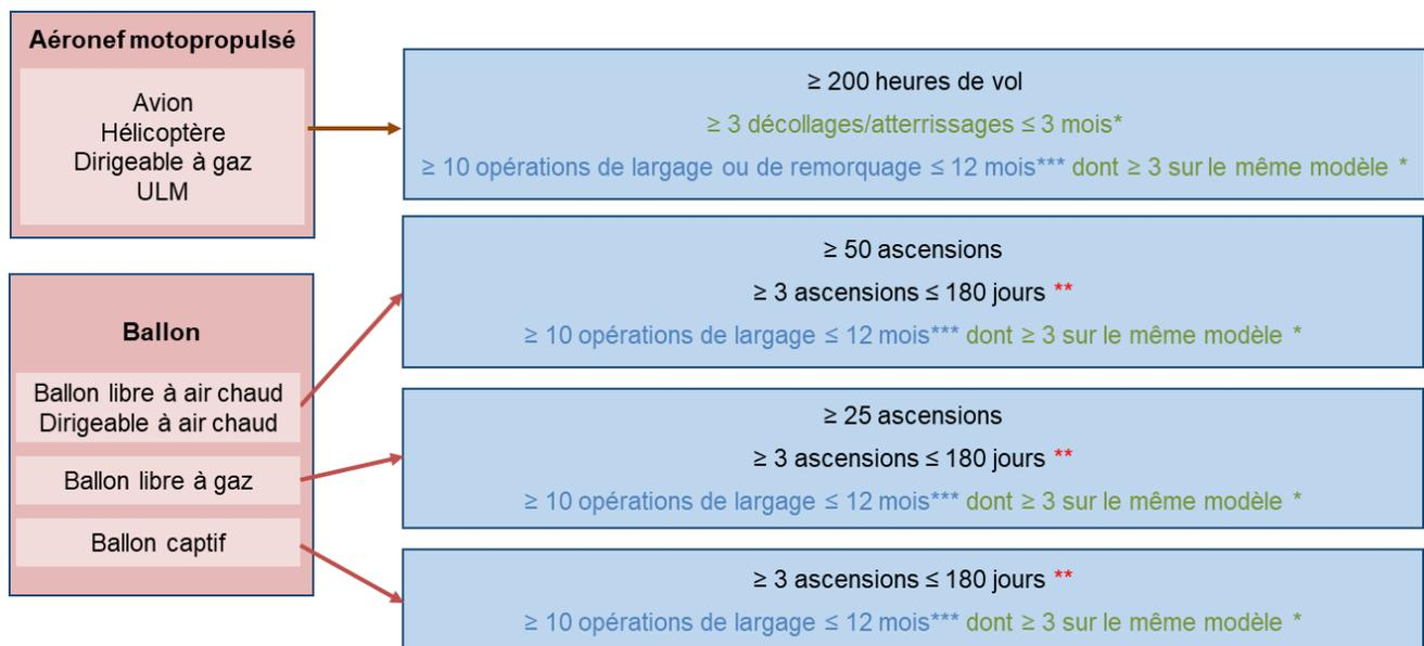
\* Avec le modèle d'aéronef utilisé pour participer au SAP
